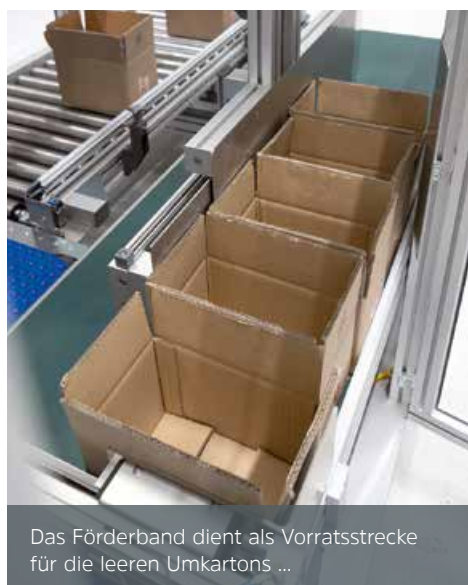
... auf der Rollenbahn werden die gefüllten Kartons abtransportiert. Zum Schluss werden sie noch mittels einer Kontrollwaage hinsichtlich der Packmenge geprüft.
